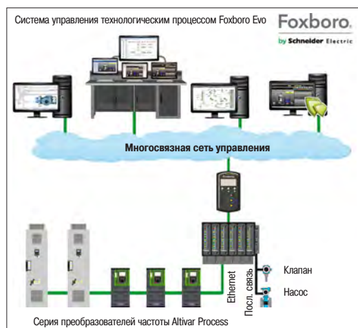
Преобразователи частоты Altivar Process в системе управления Foxboro Evo
