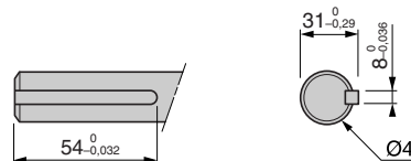
Конец вала, расположение шпонки при монтаже по NEMA (1)
