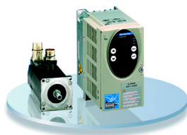
Сервоприводы Lexium 05: от 4 до 25 А BSH двигатели: от 0,5 до 36 Н·м
