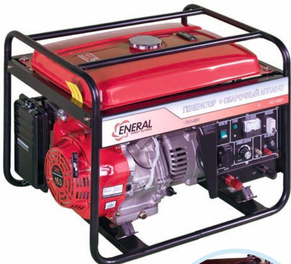
Сварочные электростанции этой серии позволяют использовать их не только для сварочных работ, но и в качестве однофазного источника независимого питания. Выгодно отличает их высокая надежность, большой ресурс двигателя и увеличенный топливный бак.
