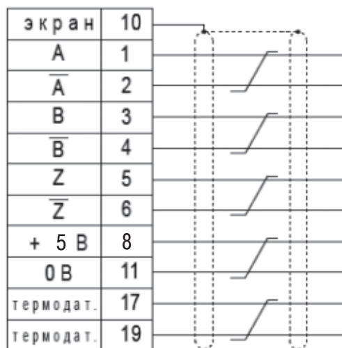
Рис.7.5.2.а Кабель энкодерный КД-Т-0-1-хх. (свободные выходные выходы)
